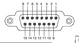
Pin 1 – 12 : CH1 – CH12 Pin 13 : not connected
