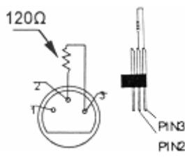
Es empfiehlt sich eine DMX-Terminierung wenn das DMX-Kabel eine große Distanz überbrücken muss oder in einer Umgebung mit vielem elektrischen Geräusch verwendet wird (z.B. Diskothek). Die Terminierung verhindert Korruption des digitalen Kontrollesignals durch elektrisches Geräusch. Die DMX-Terminierung ist nur ein XLR-Stecker mit einem Widerstand von 120Ω zwischen Pol 2 und Pol 3. Dieser XLR-Stecker wird dann in den XLR-Ausgang am letzten Gerät gesteckt. Siehe Abbildung links.
